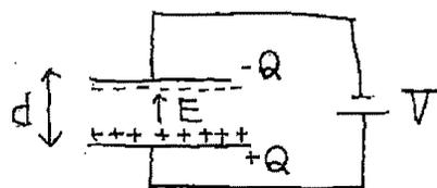
コンデンサ内の電場を  $E$ 、極板内の電荷を  $\pm Q$  とすると、下の極板で作られる電場  $E_+ = \frac{E}{2}$  が上の極板の  $-Q$  に作用するので、
