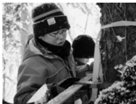
大きな輪尺を使って、森の樹木の身体測定
