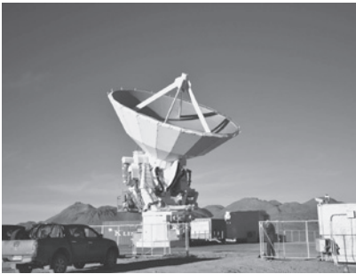
アタカマ砂漠に設置されているASTE望遠鏡。開口直径は10mで、サブミリ波帯の観測が可能な鏡面精度を持つ。
