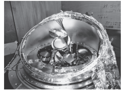
望遠鏡から下ろした後、カメラ本体から検出器・読み出し回路の取り外しを行った。写真中央は低温研技術部を中心に設計・製作した4K冷却光学系モジュール。
