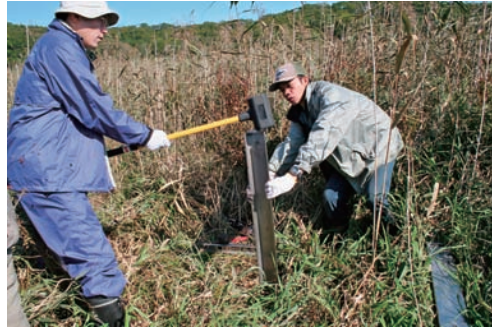
堆積物をとりだす容器（スラッカー）をハンマーでたたいて埋める
