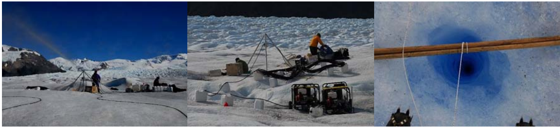
図 2. ペリート・モレノ氷河における熱水掘削の様子。熱水ジェットで氷を融かしながら，約 2 日間で約 500 メートルを掘削しました。
