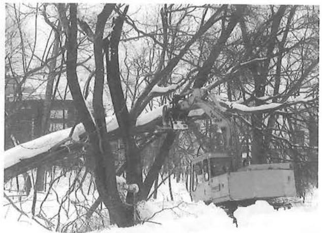
写真12 積雪期の重機による倒木の処理
