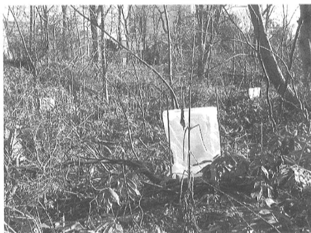
図3 積雪時用の円柱状シードトラップ
