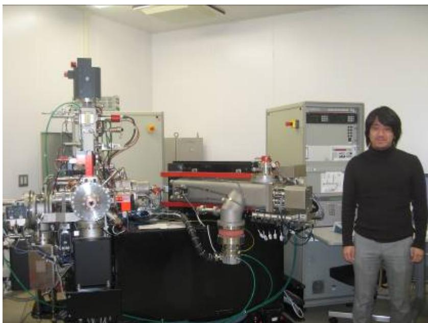
図4. 二次元高分解能二次イオン質量分析計(ナノ・シムス)
