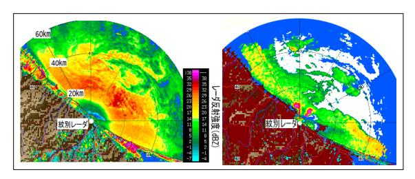
流氷がオホーツク海沿岸に接近した 2013 年 1 月 19 日 14 時 05 分の, 荒天時の観測例。左図のレーダ反射 強度(従来の観測手法)のみでは海水面と流氷の区別ができないが, 新しく開発した手法を用いた右図では 流氷域(海上の白い領域で, それ以外は海水面)が見事に検出されている。
