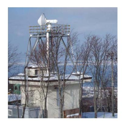
紋別市大山に設置した北海道大学低温科学研究所のドップラーレーダのパラボラアンテナ(鉄塔の上部に 設置)と送受信や信号処理装置などが入ったシェルター(地面に置かれた銀色の箱)である。
