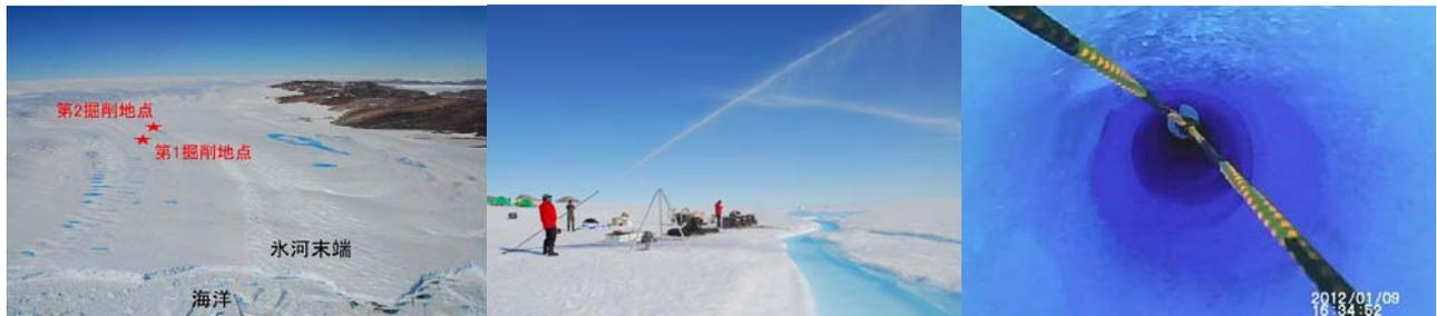
図 3. (左) ラングホブデ氷河の末端から上流を望む写真。氷河末端から 2.5~3 km の地点で掘削を実施した。(中) ラングホブデ氷河上での熱水掘削の様子。(右) 観測を行った掘削孔。
