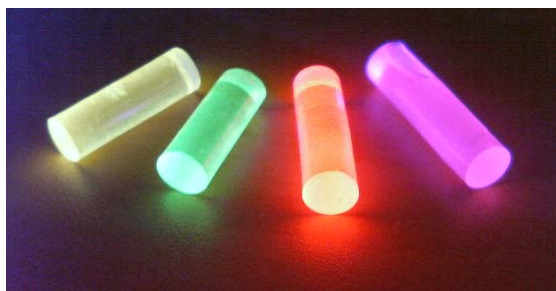
紫外光を効率よく赤色光へ変換するカメレオン発光体
