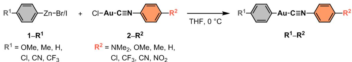
図2 48種のR<sup>1</sup>-R<sup>2</sup>を合成するための反応式
