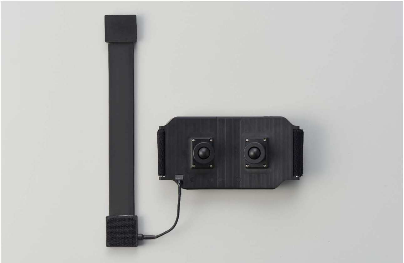
図3 ウェアに内蔵したセンサユニット（左が加速度センサ，曲げセンサ，右突起部2つが筋硬さセンサ）
