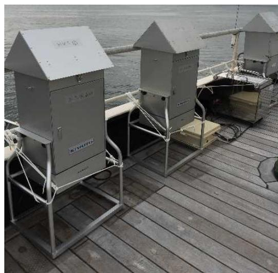
図 1. 学術研究船白鳳丸から望む西部北太平洋 (左図), 船上デッキに設置された大気エアロゾル捕集装置 (右図)。
