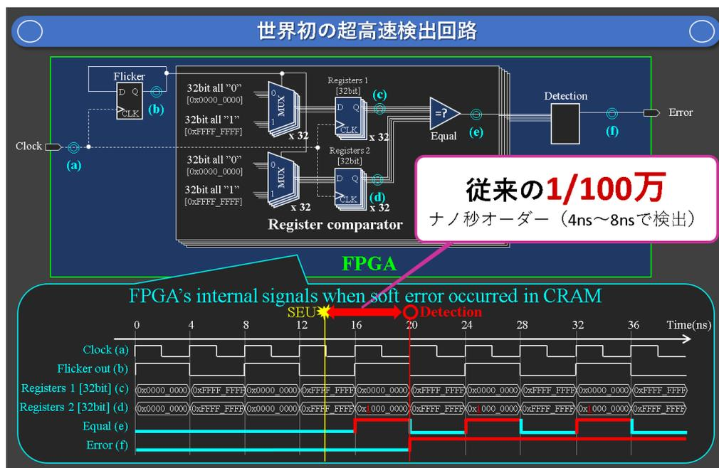
図 7 超高速エラー検出回路
