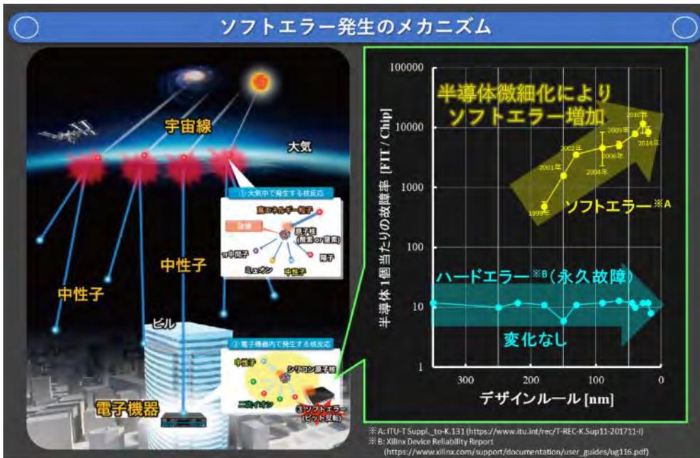
図1 ソフトエラー発生メカニズム
