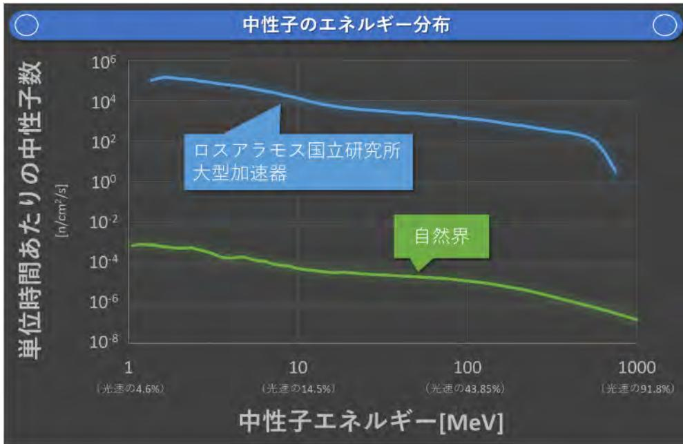
図 9 ロスアラモス国立研究所中性子エネルギースペクトル
