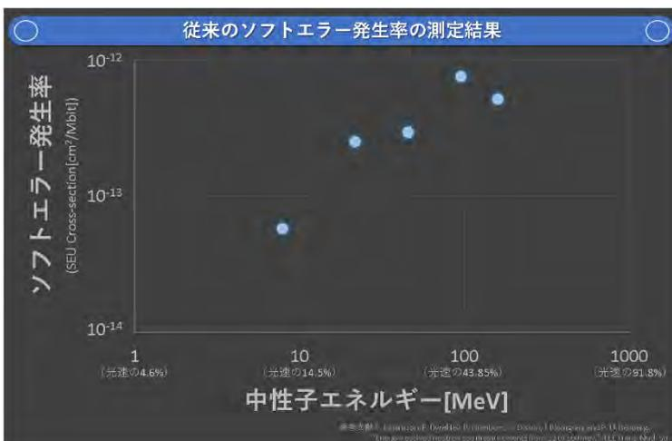
図3 従来の技術(ソフトエラー発生率の測定結果)
