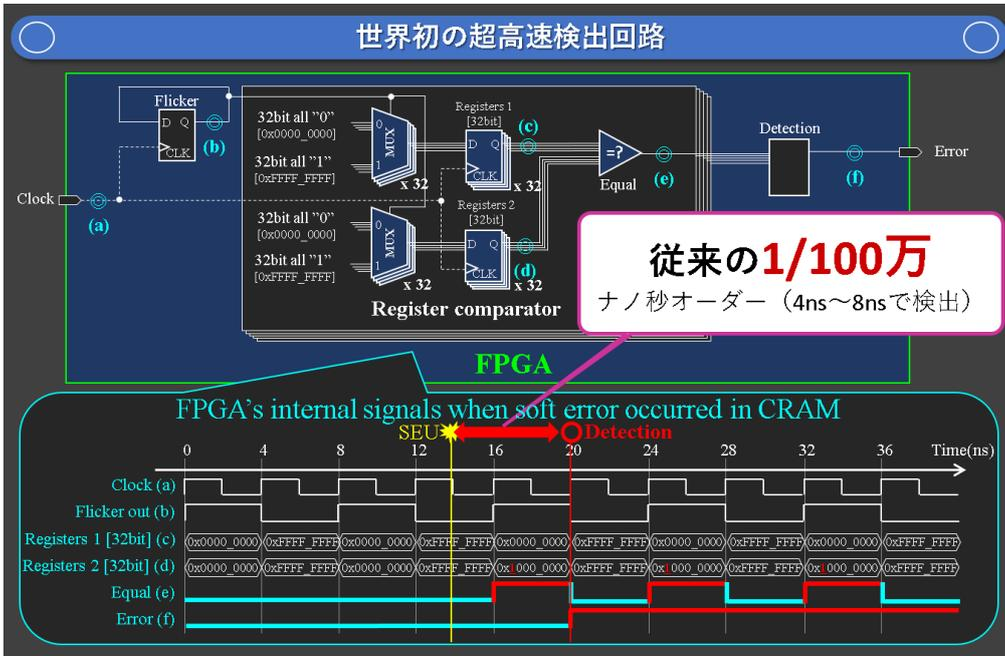
図7 超高速エラー検出回路
