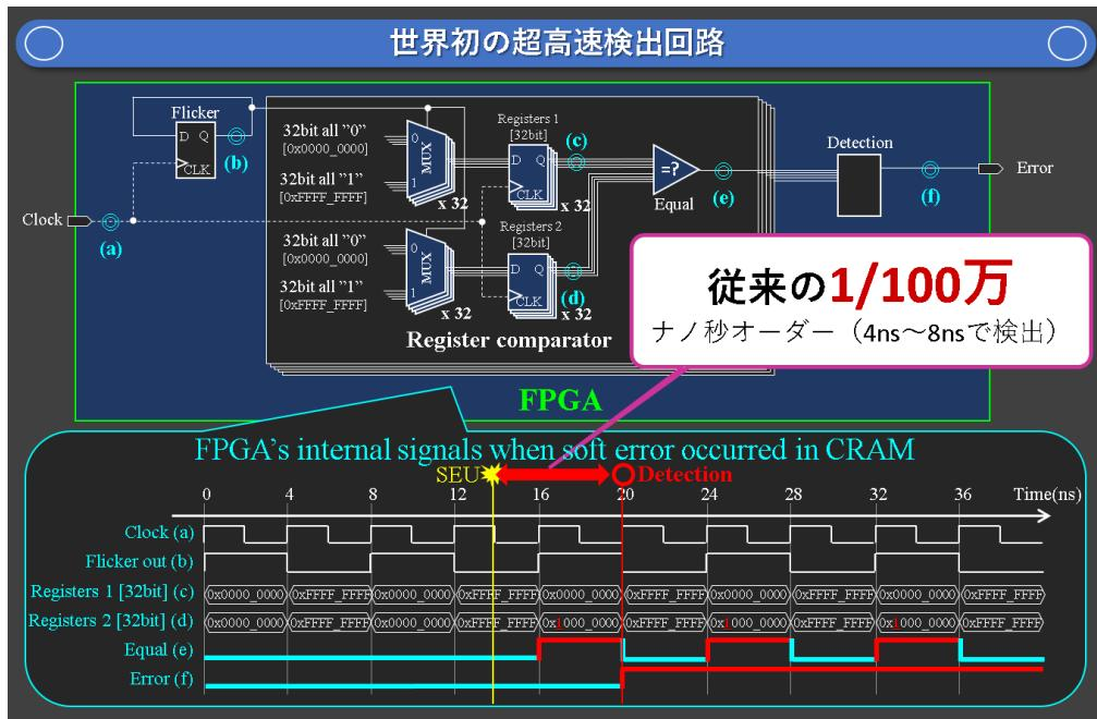
図 7 超高速エラー検出回路
