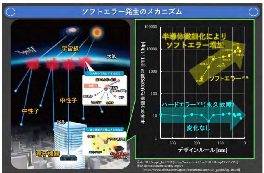
図 1 ソフトエラー発生のメカニズム
