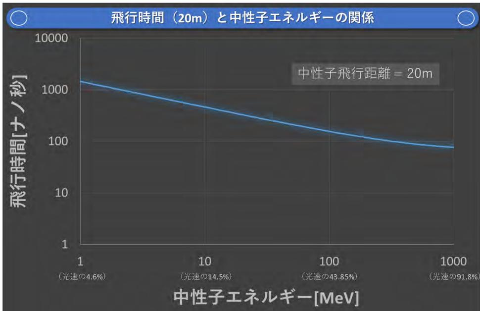
図 6 飛行時間と中性子エネルギー (20メートル飛行時)
