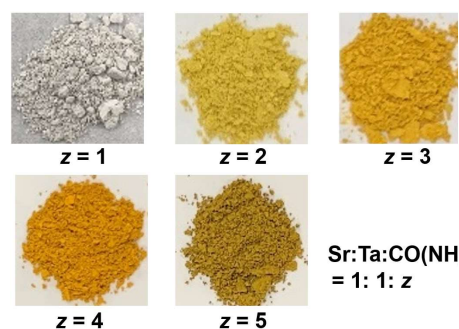
図1 様々な尿素添加比（ z ）で合成したストロンチウム-タンタル系酸窒化物の写真
