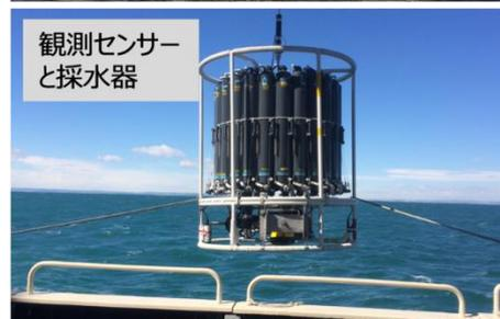
左：南大洋から北部北太平洋における観測点。右上：太平洋中央部の観測を実施した海洋研究開発機構の学術研究船白鳳丸。右下：海洋観測を行う各種センサー類と海水試料を採取する 12L のニスキン採水器。
