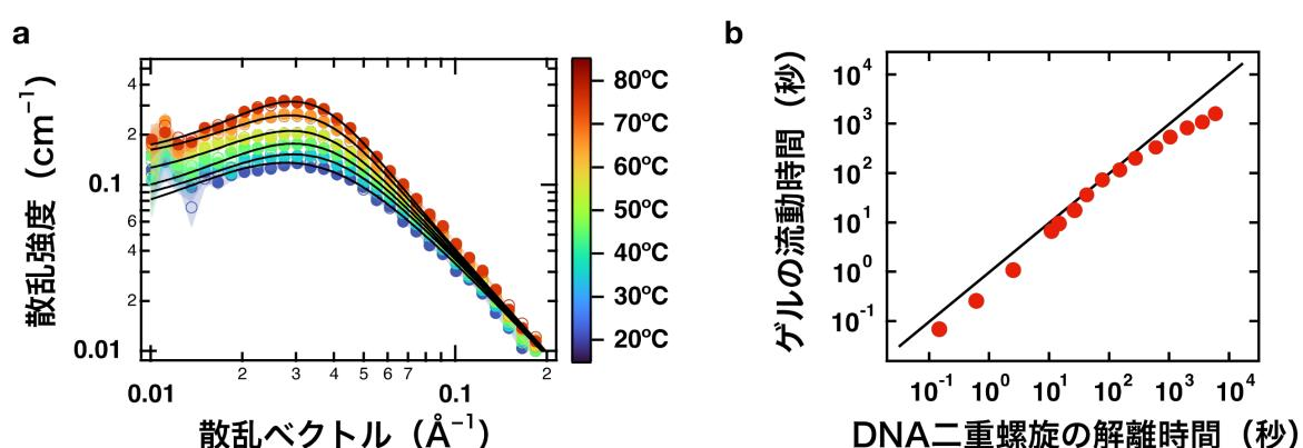
図2. (a)小角中性子散乱プロファイル。(b)ゲルの流動性とDNA二重らせん構造の解離時間の関係。両者は、0.1 – 2000秒という幅広い時間領域で一致した。
