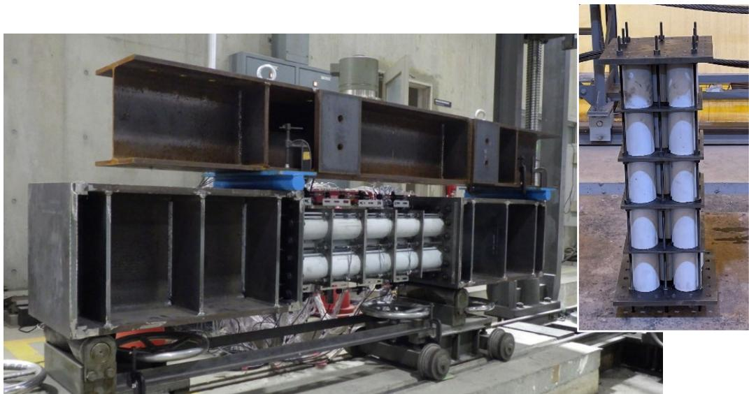
図 4：CCC 柱部材の耐震性評価試験
