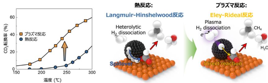
図 プラズマにより生成された水素原子の低温メタネーション反応促進の模式図。熱反応においては、触媒（黒い球の集合）上で水素分子（H 2 ）が不均一（heterolytic）に解離（dissociation）し、生成された水素原子が順に移動して反応が起きる。一方プラズマ反応では、生成されたフリーラジカル状態の水素原子が吸着種と直接反応してメタンが生成される。
