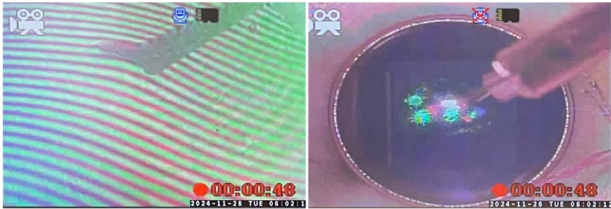
図 2. 装置内で炭素の蒸気から炭素粒子が生成する様子(左:二波長干渉縞画像、右:可視光画像)。打ち上げから約 133 秒後。左画像の干渉縞の変化から、粒子が生成する時の温度と濃度が決定でき、宇宙ダストの生成メカニズムの解明に必須の物理量の決定につながる。右画像の中心で光っている部分が星に相当し、そこから発生する蒸気から微粒子（星の欠片の類似物）が生成している。
