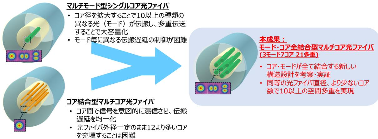
図 1： 新たに考案・実証したコア間・モード間光結合型光ファイバの概要
