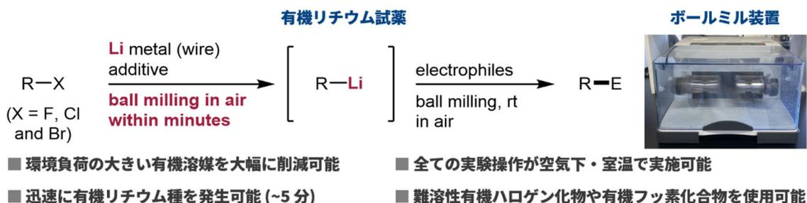
メカノケミカル法を用いることで、空気下・室温で有機溶媒をほとんど使用せずに、有機リチウム試薬を調製し、有機合成に利用することに成功。医薬品や機能性材料の合成において、生産プロセスのコストカット及び環境負荷の軽減につながることを期待される。
