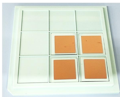
図2. 著者らが作製した窒化チタンの薄膜
