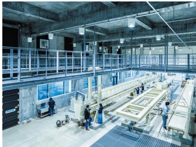
図 1. 北海道大学工学研究院土木工学研究棟地球流体実験内の造波水槽 (左端)。
