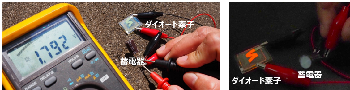
図1 同一素子で太陽光の下で発電し電気を貯め、自分自身で貯めた電気で発光する様子
