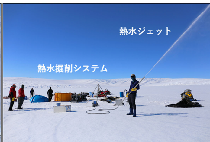
研究を行った南極ラングホブデ氷河と熱水掘削の様子
