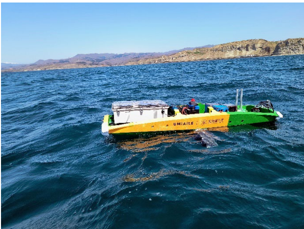
北海道乙部町沿岸海域にて魚群探知機及び多項目水質計による海洋観測中のASV
