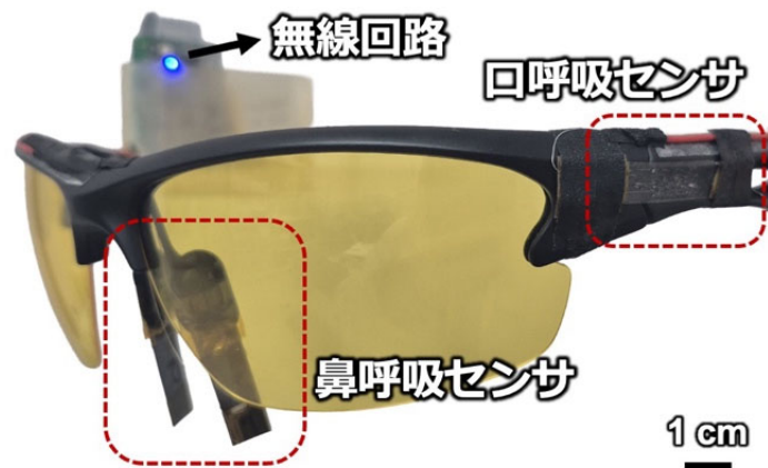
図 3. 開発した呼吸数、呼吸深度、血圧・心拍変動を無線計測可能なスマートグラス。
