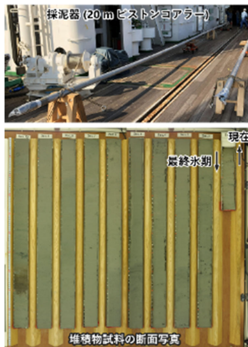
図3 本研究で使った堆積物試料の採取に用いた採泥器 (20 m ピストンコアラー) と試料の断面写真
