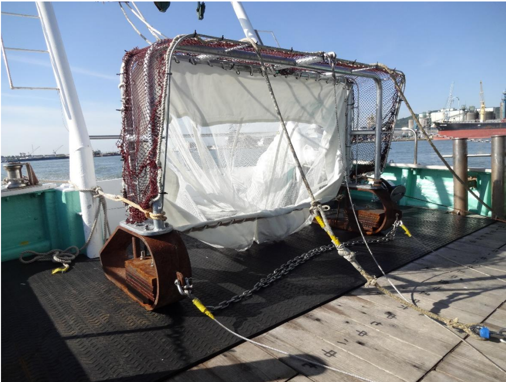
図 1. 福井元教授らが開発した深海魚採集用ビームトロール（東海大学調査船北斗）。
