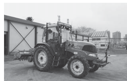
自ら倉庫から出て作業して戻る自動運転トラクター
