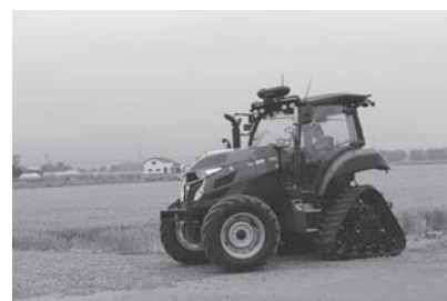
デモンストレーションで自動運転技術により無人走行するトラクター
