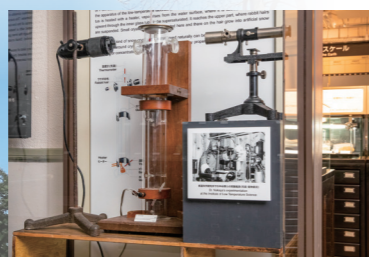
二重ガラス管人工雪製作装置。総合博物館に他の資料とともに展示されている
