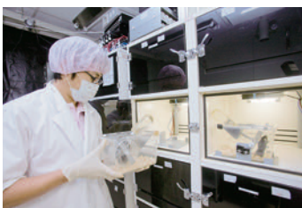
図 1 個別に照明を調節できるマウス行動計測システム
